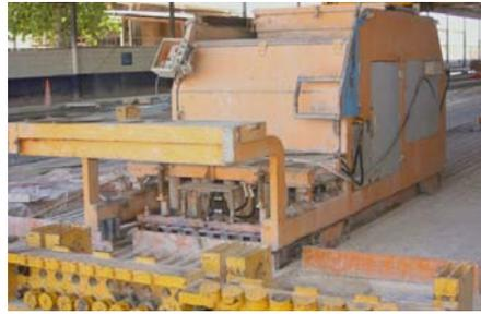
**Figura 1** Maquina Extrusora al inicio de la pista
