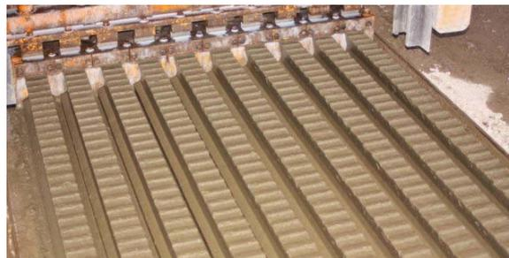
**Figura 2** Sección de la vigueta en estado fresco
